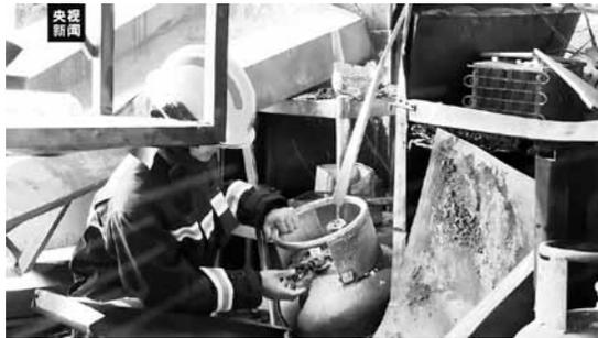
▲爆炸后现场,一个液化石油气瓶的减压阀被烧掉大半
